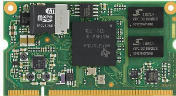
Fig. 1. – Carte d'extension avec système embarquée (Wikipedia Commons).
